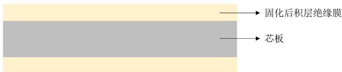
图E.1 燃烧性测试试样示意图
